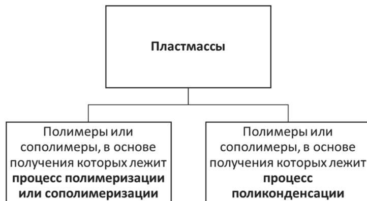
Рис. 1. Деление пластмасс по типу мономерных звеньев
